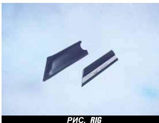
**ЛИНЕЙКА** Линейка для контроля плоскости скользящей поверхности длиной 125 мм
