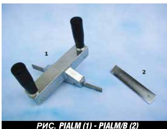
**РУЧНОЙ РУБАНОК** Ручной рубанок - Ширина 150 мм (1)
