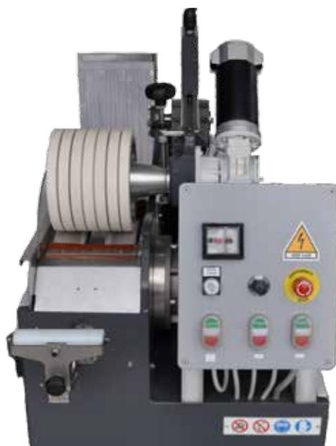
ДОПОЛНИТЕЛЬНО: ДВИГАТЕЛЬ АВТОМАТИЧЕСКОЙ ПОДАЧИ С РЕГУЛИРУЕМОЙ СКОРОСТЬЮ
